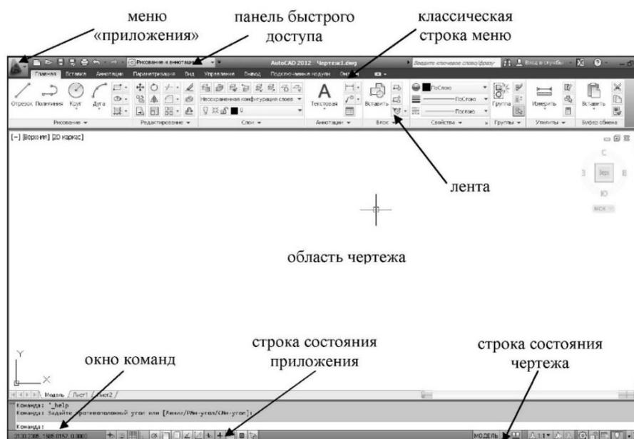
Рисунок 2.3 Интерфейс AutoCad 2012
